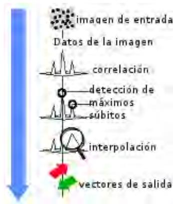
Figura 2.5: Diagrama de proceso de datos en PIV.
