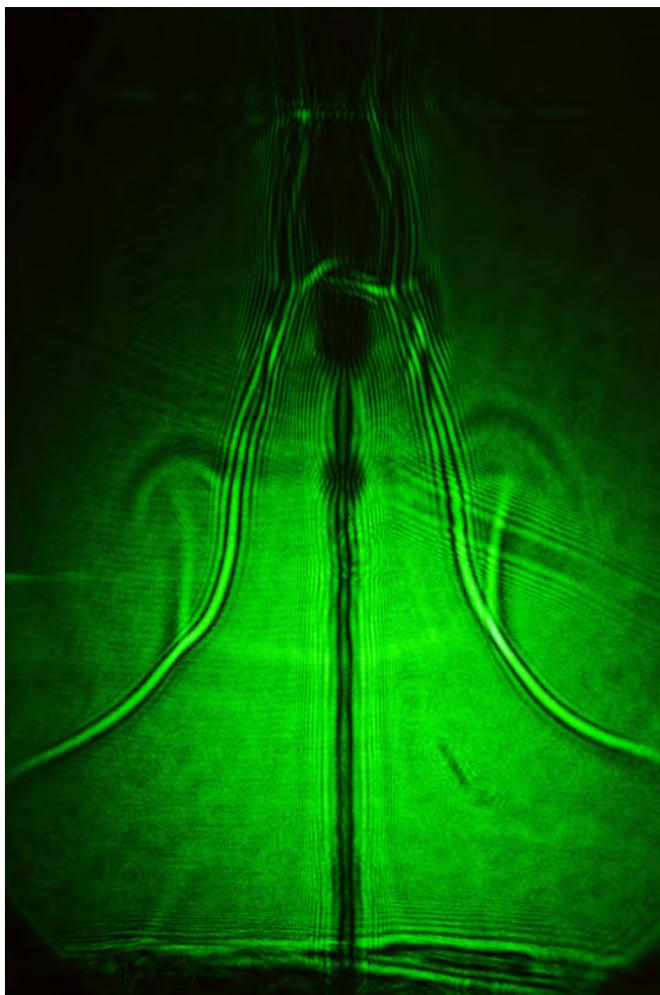
Figura 4.16: Estructura del chorro subiendo.
