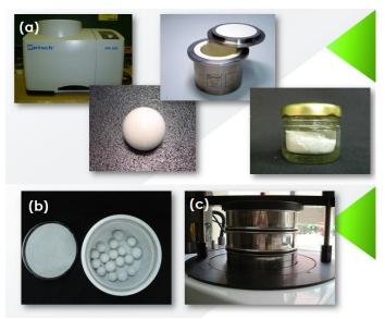
Figura 20 Molino planetario de Zirconio (a), molino de bolas cerámico (b) y tamizador con tamices(c).
