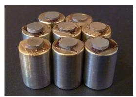
Figura 19 Pastillas de los cementos hidratados recubiertas de oro Fuente directa
