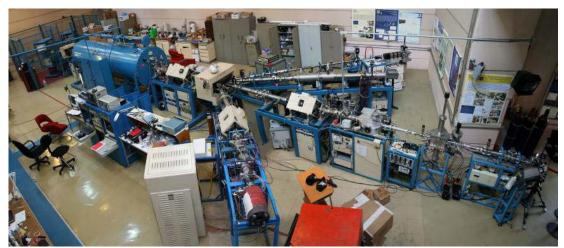
Figura 9 Acelerador Tandem Peletrón IFUNAM Fuente directa
