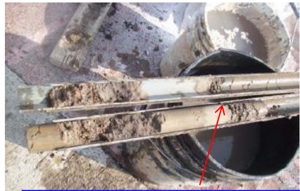
VISTA DE MUESTRA RECUPERADA OBTENIDA CON PENETROMETRO.
