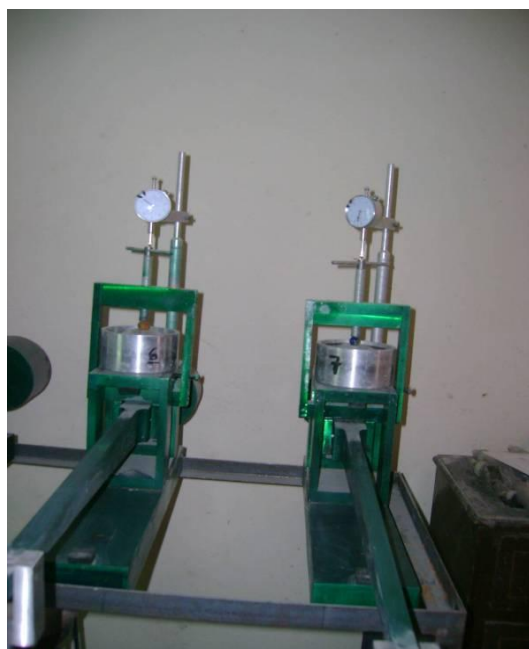
PRUEBA DE CONSOLIDACIÓN
