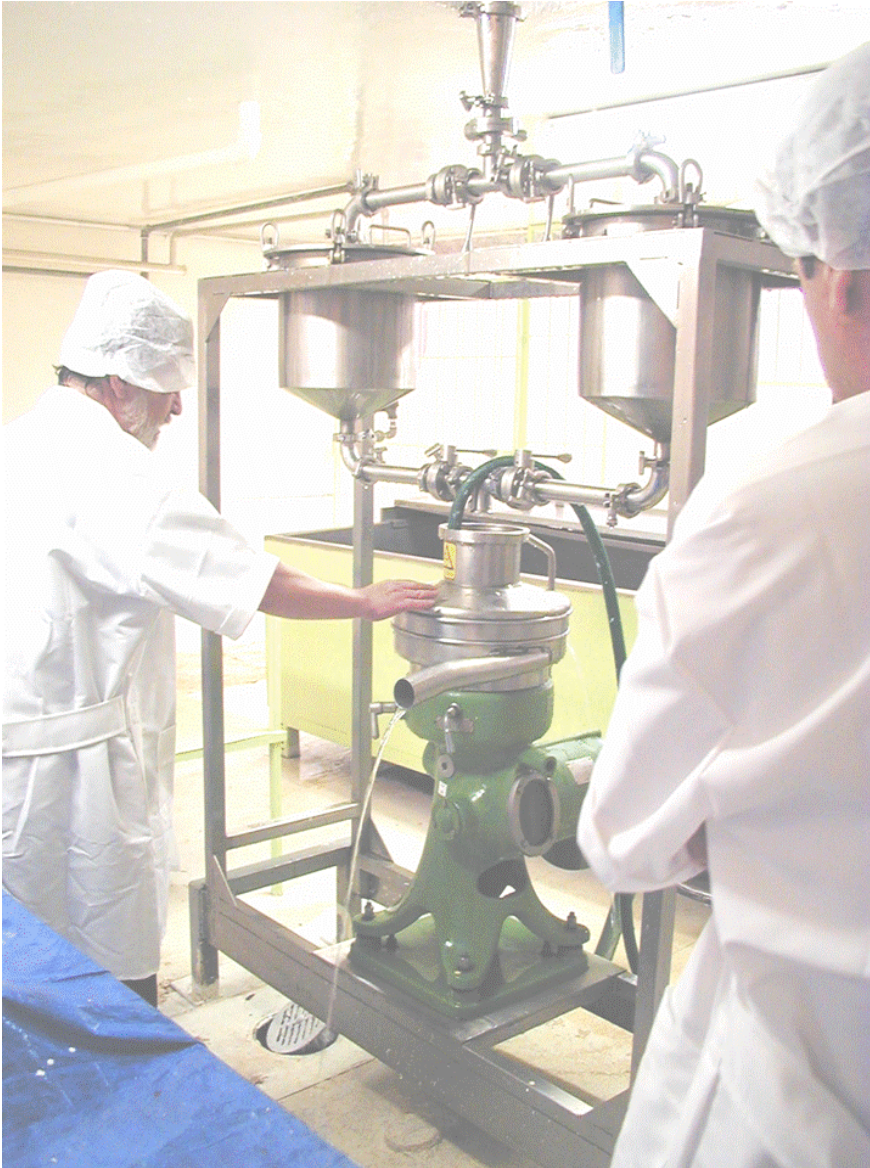
Fig. 24. Centrifugación continua de la sangre porcina y separación en paquete celular y plasma.
