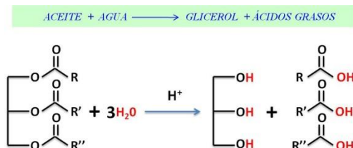
Figura 2.18: Hidrólisis de un triglicérido.
