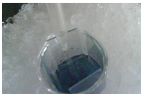
Figura 2.3: Proceso de síntesis de películas delgadas de polianilina.
