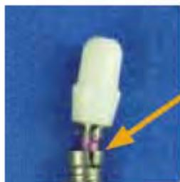
Figura 44 en las pruebas de fatiga dinámica, el implante de titanio fracasó antes que la unión cementada entre el óxido de zirconio Lava® y el titanio.
