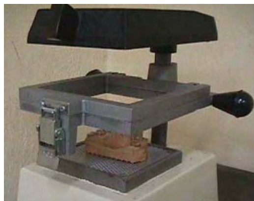
Fig.37 Máquina vaccum, para acetatos.
