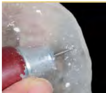
Fig. 69 Se realizan perforaciones con una profundidad no mayor a 1 mm.
