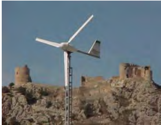
Figura 3.3.2: Aspecto general de un aerogenerador de pequeña capacidad. Fuente: energiadiario.com
