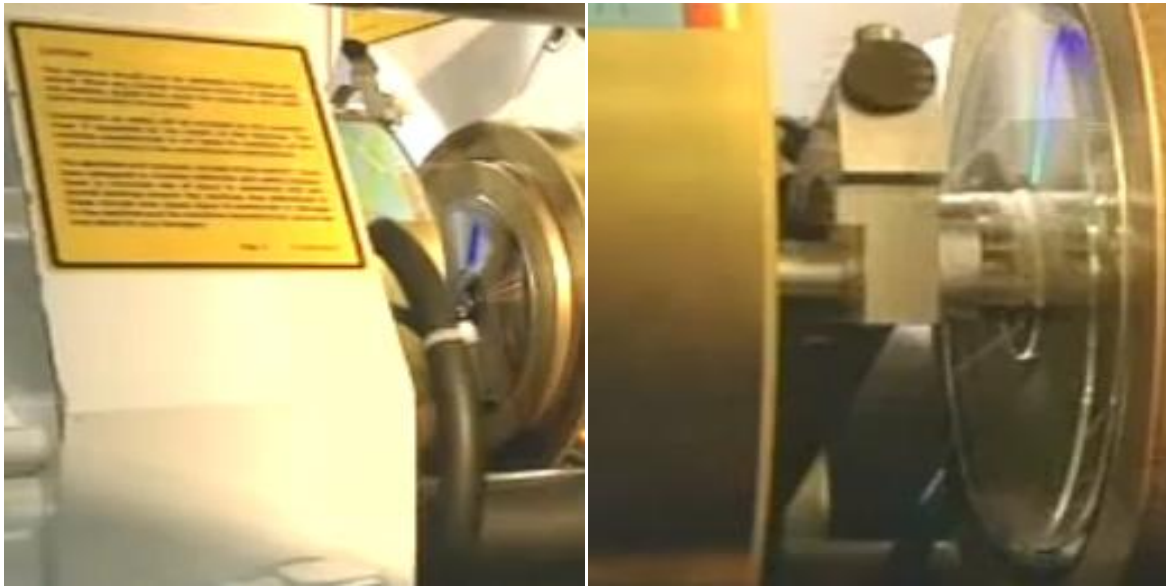
Figura 6.9. Prensado del policarbonato.
