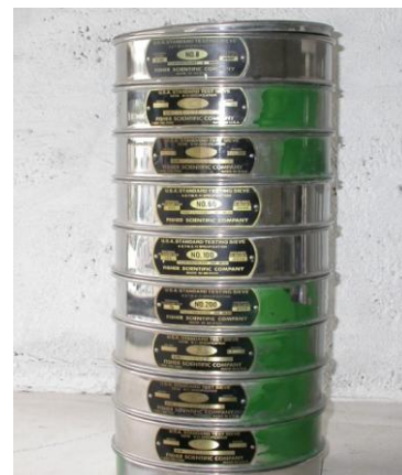
Figura 6 Juego de tamices y equipo Rotap empleado para la determinación del tamaño de partícula.
