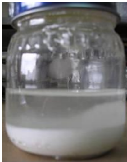
Figura 11. Aparición del fenómeno "cake" en la solución donde se incremento la viscosidad.
