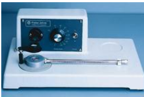
Figura 7. Equipo de punto de fusión Fisher-Johns empleado en el laboratorio para esta determinación.
