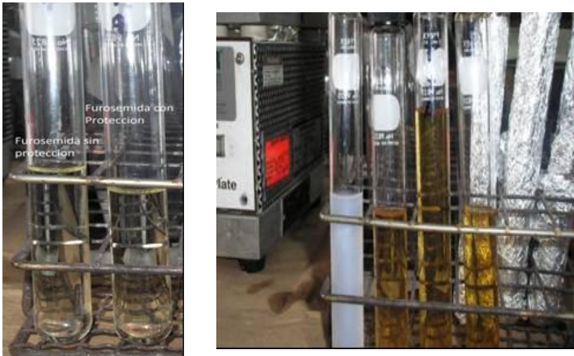
Figura 9. Efecto de la luz en una solución de furosemida con acetona.
