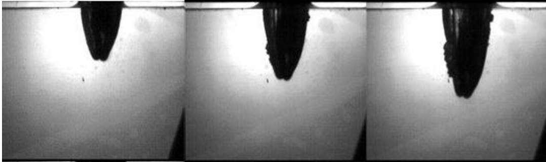
Figura 26. Formación de la cavidad para el modelo a escala.
