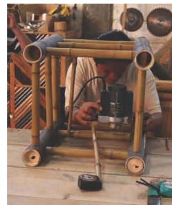
Rectificado de una perforación con router manual - Cuetzalan, Puebla
