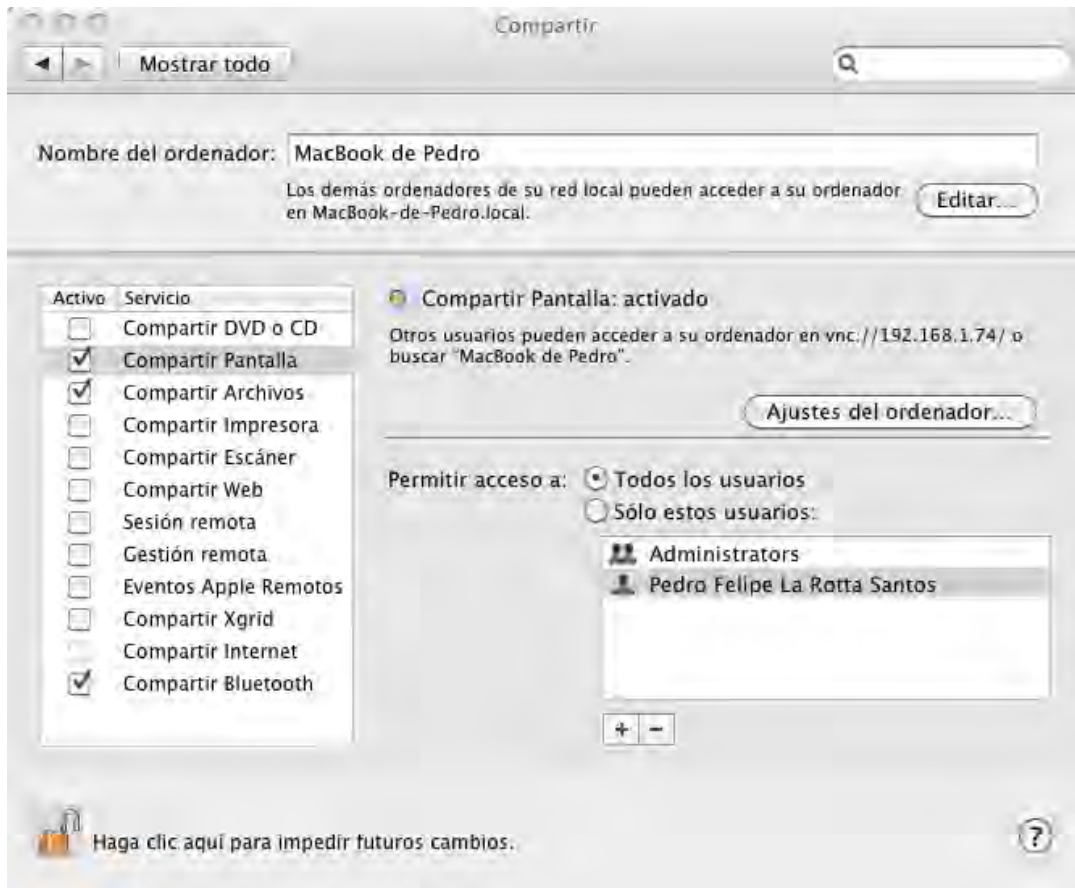
Figura 10. Configuración del servidor VNC en la computadora donde se encuentra la consola.
