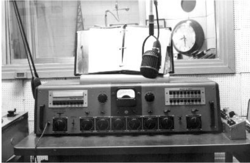
Figura 2. Consola de mezcla RCA 76-B5.
