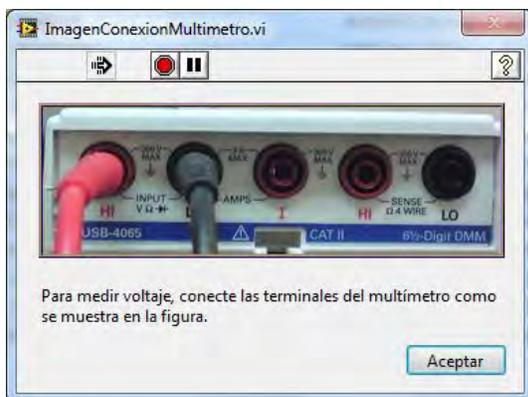
Figura 3.4-20. Conexión para medir voltaje.
