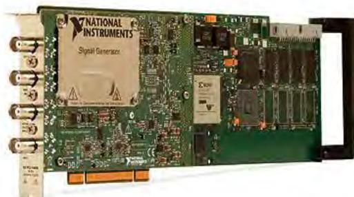
Figura A.1.1 Tarjeta PCI-5406 (Generador de funciones).
