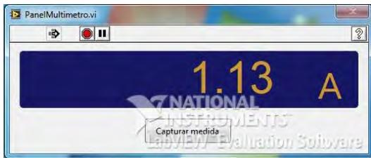
Figura 3.4-18. Medición de corriente
