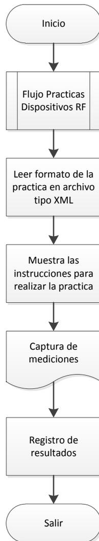
Figura 2.1-3. Diagrama de flujo de FlujoPracticaDispositivosRF.vi.
