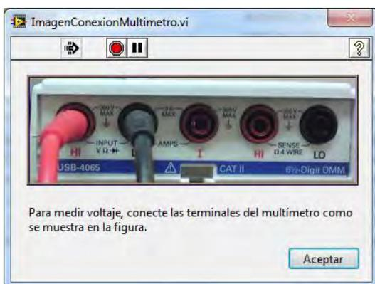
Figura 3.4-12. Conexión para medir voltaje.
