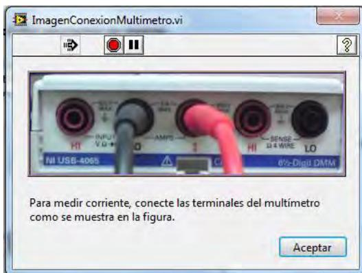
Figura 3.4-8. Conexión para medir corriente.
