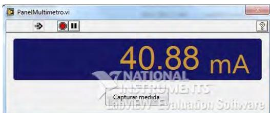
Figura 3.4-10. Medición de corriente.
