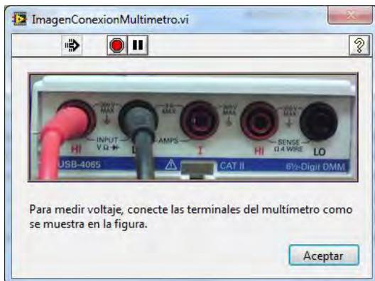
Figura 3.4-44. Conexión para medir voltaje.
