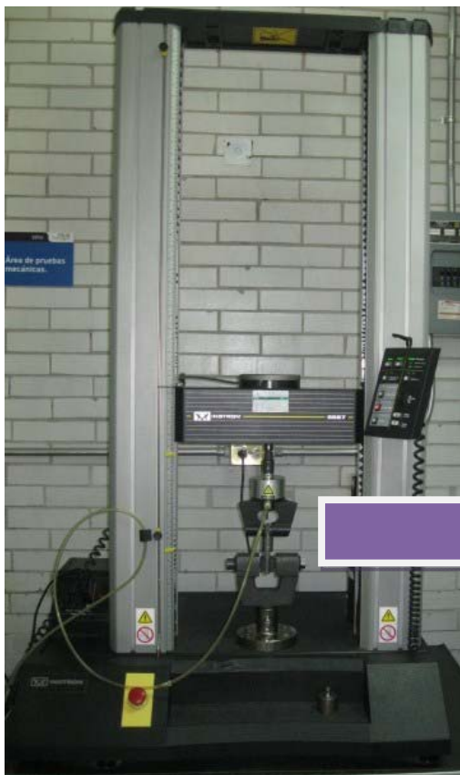
Foto N° 8 Instrón modelo 5567 y muestra antes de la prueba
