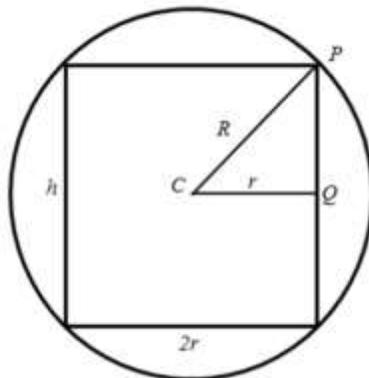
Considerando un cilindro recto con base circular de radio  $r$  y altura  $h$  (inscrito en una esfera de radio  $R$ ). Si se analiza una sección transversal del cuerpo, la figura representativa de ellos es la misma que se tiene para una circunferencia de radio  $R$  y un rectángulo inscrito en ella de base  $2r$  y altura  $h$ .
