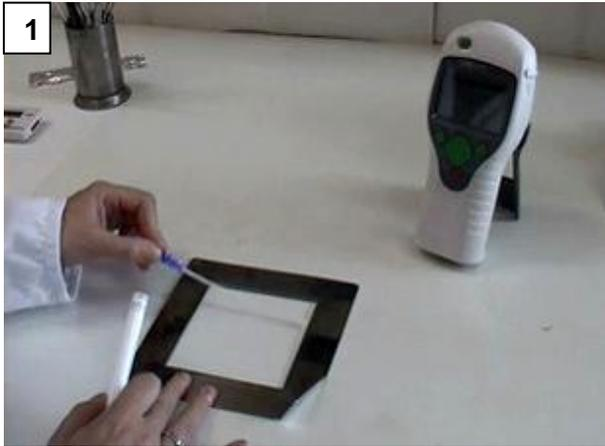
Se muestrea una superficie de 10x10 cm con el hisopo, mediante 10 trazos en sentido vertical y 10 trazos en sentido horizontal girando el hisopo, y cuidando no tocar con la mano la parte blanca del hisopo, ya que es común tener ATP en las manos.
