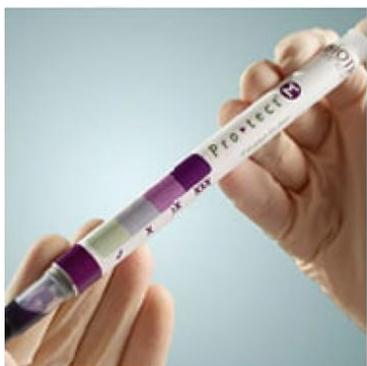
**Figura 1-5 Hisopo Pro-Tect de 3M para detección de residuos proteicos**
