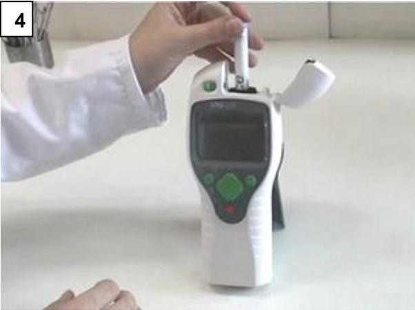
Inmediatamente después de activado y agitado, se introduce el hisopo al sistema.
