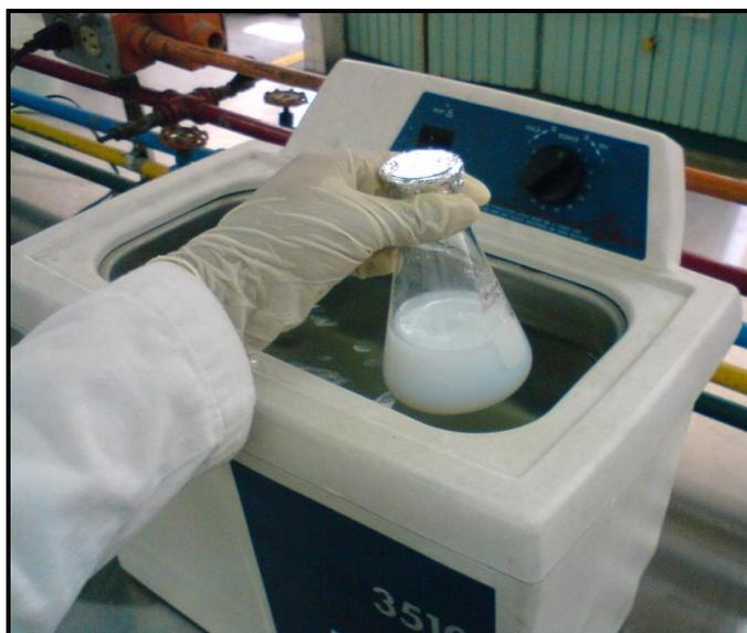
**Fig 14.** Mezclado ultrasónico BRANSON modelo 3510.
