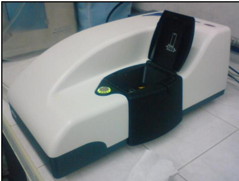
**Fig 11.** Equipo dispersor de Luz *ZETASIZER NANO-ZS90*.
