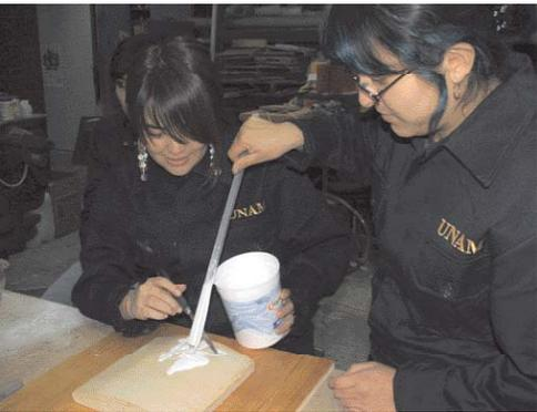
Para la medición del catalizador se necesitó trabajar con precaución para no tener efectos desagradables o innecesarios, de éste modo se pudo lograr un molde impecable. Para ello se debió tomar determinadas medidas: el uso de jeringa para el cuidado de los mililitros que se necesitan a proporción de la cantidad de caucho de silicón, la densidad que se requiere para la fluidez del silicón, la cantidad de diluyente que es aplicada para tomar con mayor exactitud la forma del molde.
