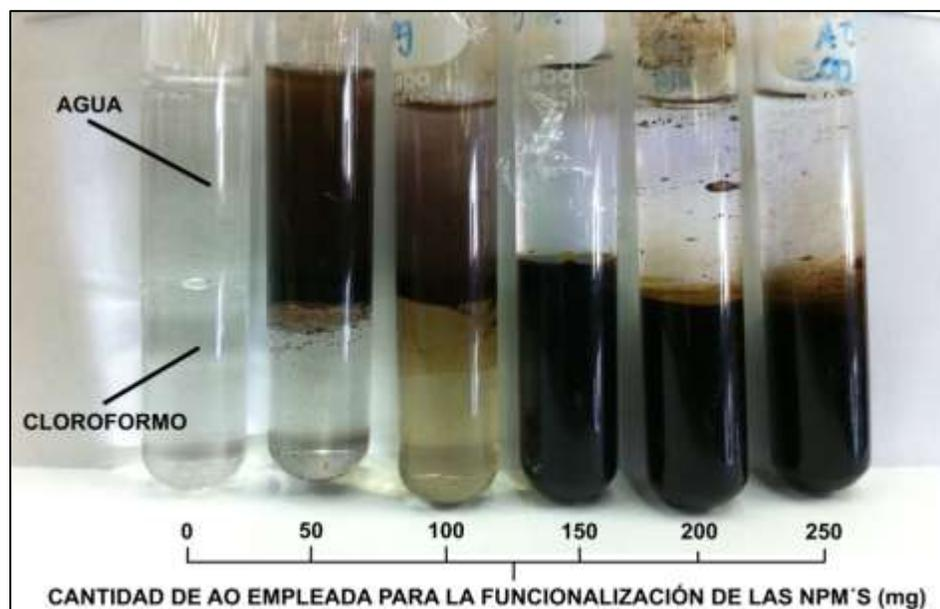
Fig. 27. Evaluación de la lipofilicidad de las NPM vs. Cantidad de AO puro adsorbido.
