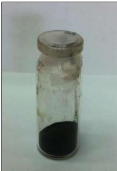
Fig. 18. NPM sintetizadas por el método de co-precipitación.
