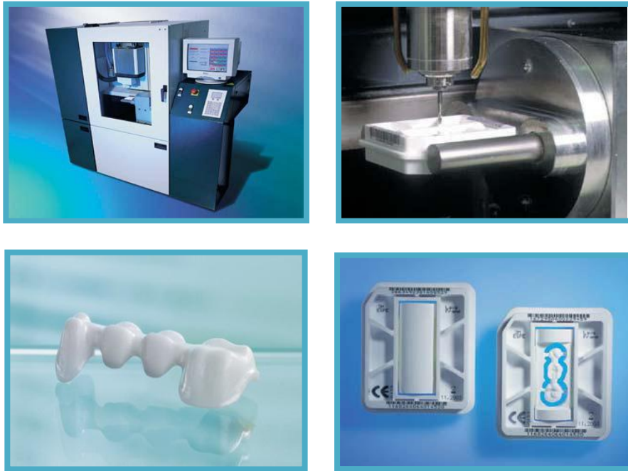
Fig. 38 Lava® Form Fresado y Bloques de Zirconia.
