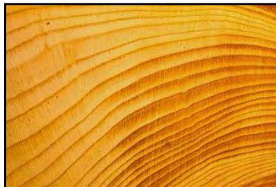
Fig. 2.10 Madera de compresión.
