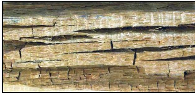
Fig. 2.12 Pudrición “parda” en una pieza de madera.
