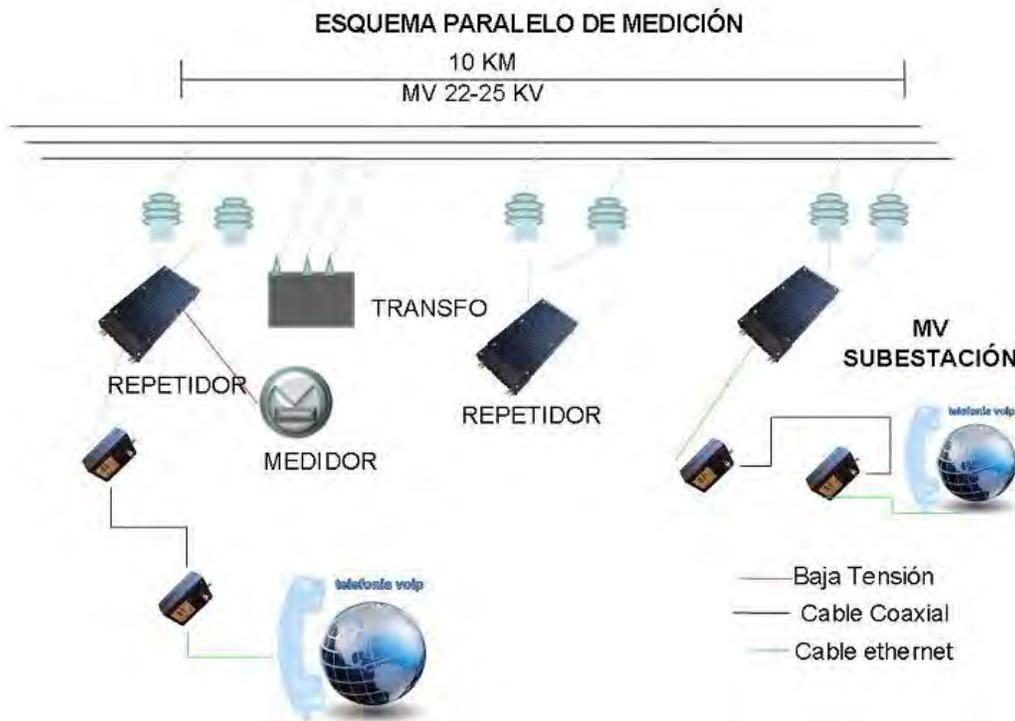
**Fig. A.1** Instalación PLC con enlace de 10 Km en media tensión
