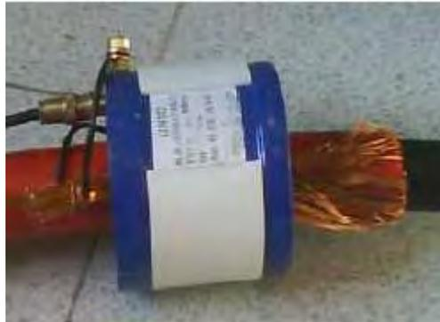
**Fig. 2.4** Acoplador inductivo de media tensión (Fuente: ARTECHE)
