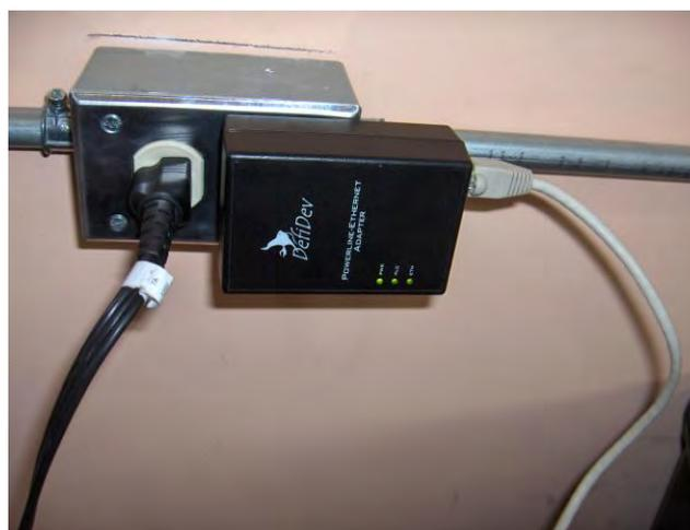
**Fig. 4.2** Módem esclavo.
