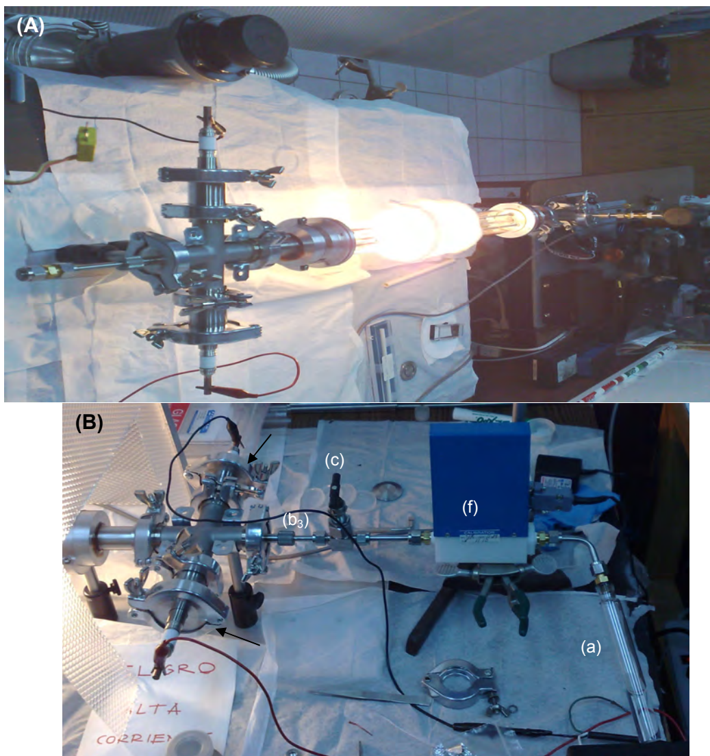
FIGURA 2.5. (A) Configuración final del sistema de PVD. (B) Sistema de admisión de gas de arrastre para el NH 3
