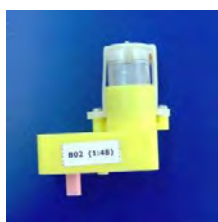
Figura 25. Motor B02, con reducción 48:1.
