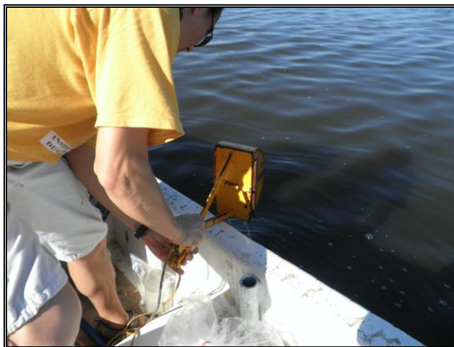
Fotografía VII.2-1 Extracción de muestra de sedimento superficial mediante draga
