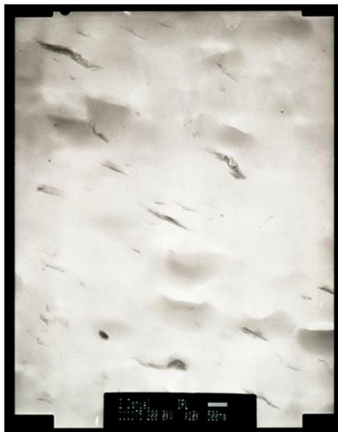
Figura 4.11. Imagen a una escala de 500 nm de PP/MMT-DDA al 5%
