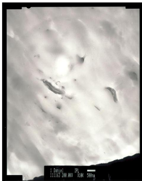
Figura 4.9. Imagen a una escala de 500 nm de PP/MMT-Arcilla al 3%
