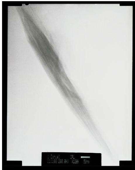
Figura 4.8. Imagen a una escala de 50 nm de PP/MMT-Arcilla al 3%.
