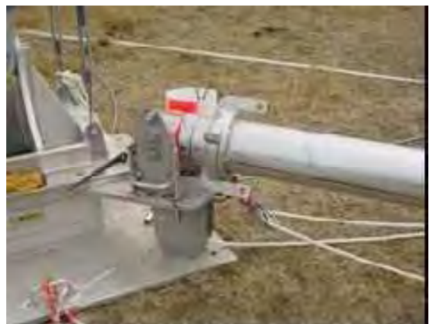
Figura 60. Ubicacion de la base de la pluma en la base de la columna
