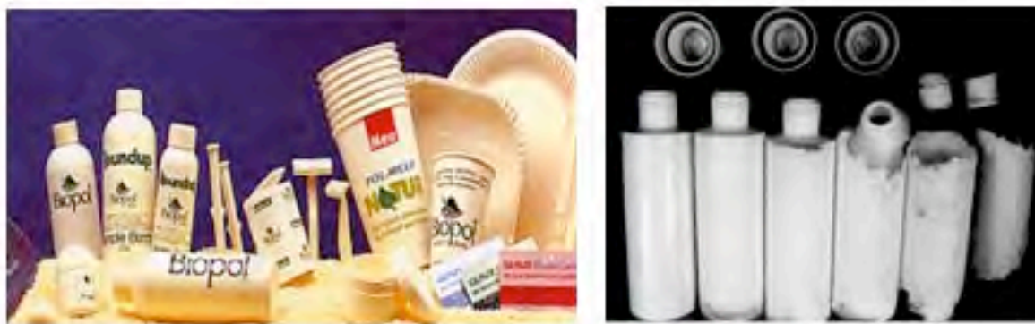
Figura 2. Usos de los PHAs. A la izquierda, diferentes productos comerciales elaborados de PHAs. A la derecha, botellas fabricadas con PHAs en diferentes etapas de degradación a lo largo de 6 meses. (Madison y Huisman, 1999; Van der Walle et al. , 2001).
