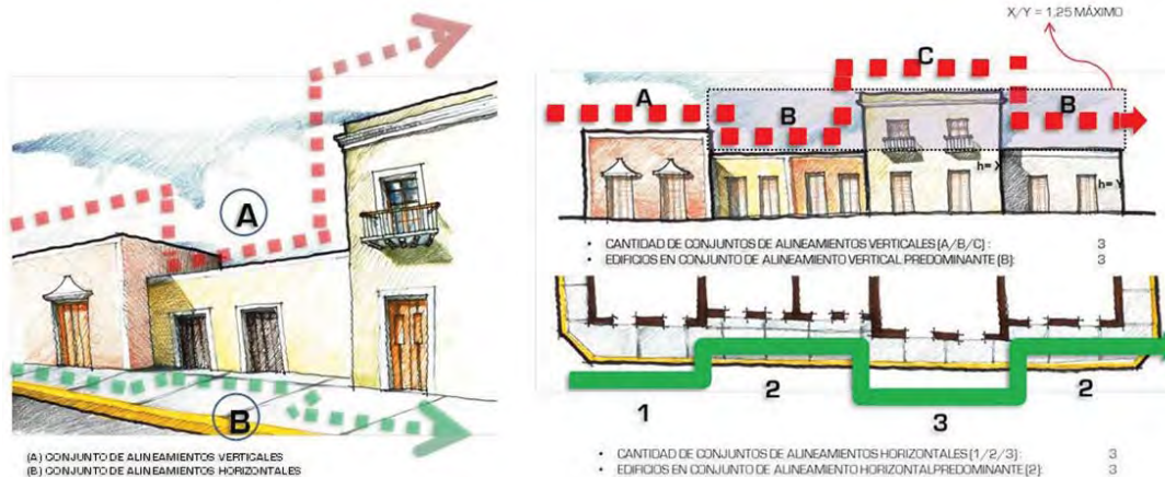
Imagen 16. Conjuntos de alineamientos horizontales y verticales, alineamientos predominantes y relación entre alturas de edificios en paramentos. Realizó: R. Reyes
