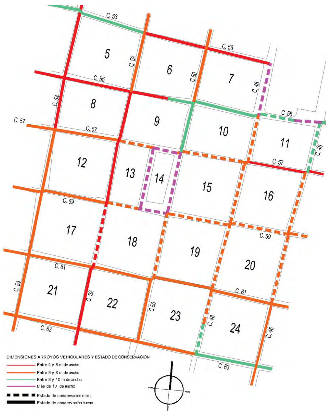
Imagen 127. Arroyos vehiculares en Mejorada. Anchos y estados de conservación. Dibujó: R. Reyes. Fuente: Trabajo de campo.
