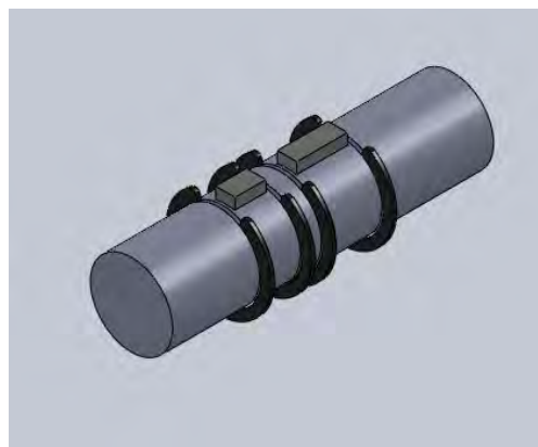
Figura 6.1.7.a) Ensamble de uno de los ejes con las cuñas y seguros e.
