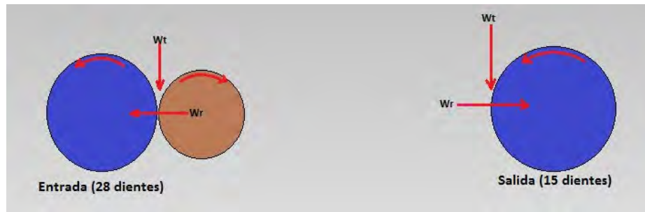
Figura 4.4.8.b) Fuerzas para el conjunto 28 dientes (E) y 15 dientes (F).
