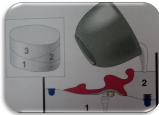
Fig. 69 Fabricación del molde auricular en tres partes.
