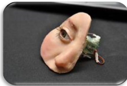
Fig. 130 Prótesis mioeléctrica fabricada por estudiantes de IPN.
