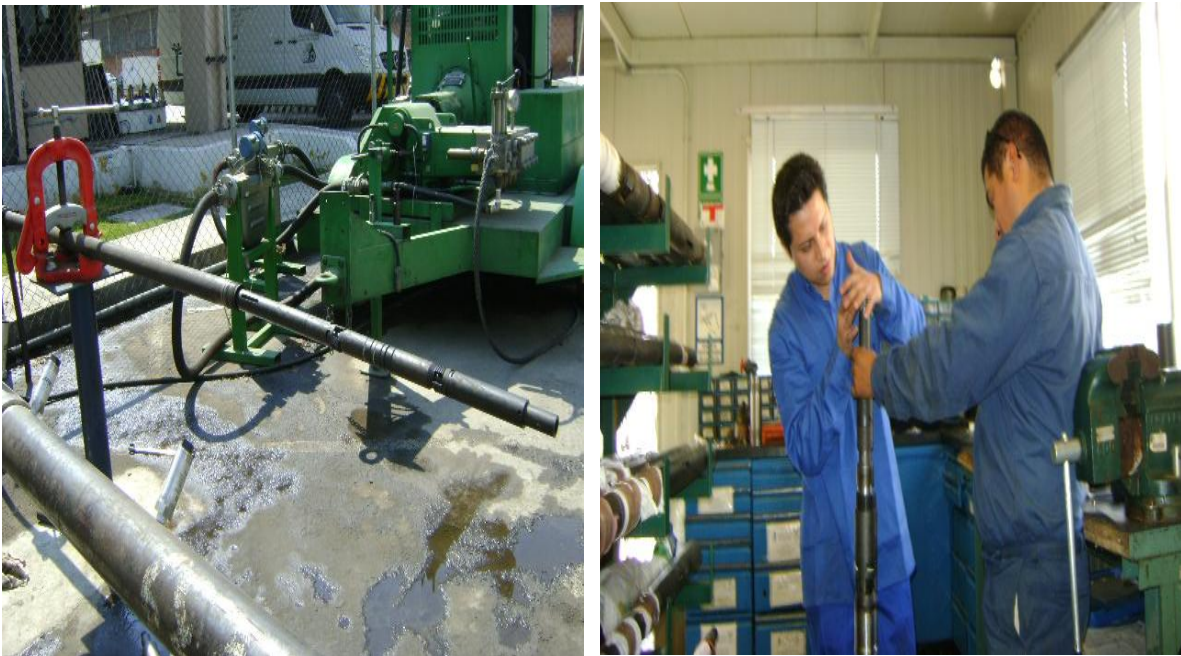
Fig. 5.8. Introducción de la herramienta en la tubería de 2 7/8".
