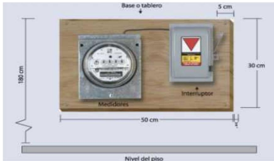
Figura 4.3 Dimensiones del tablero para servicio de una fase
