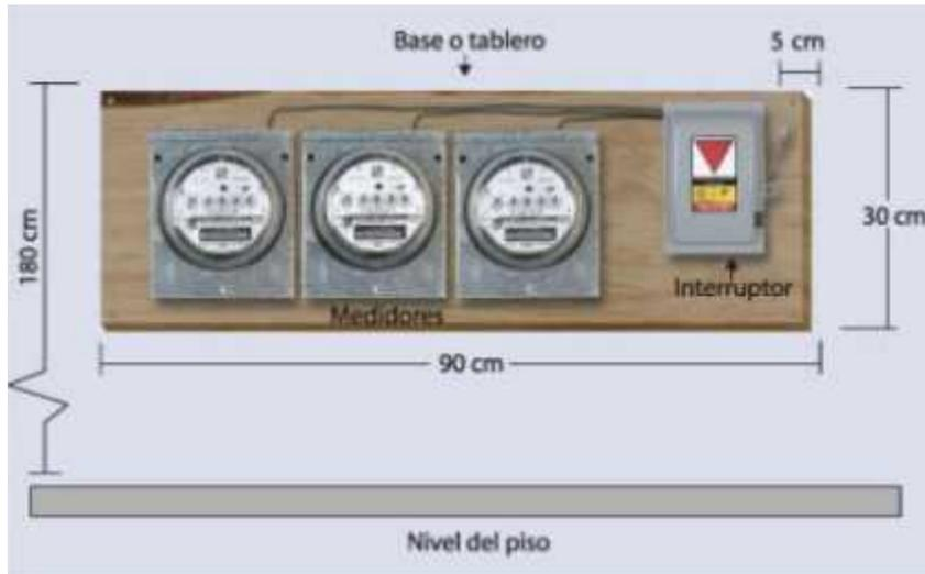
Figura 4.5 Dimensiones del tablero para servicio de tres fases.
