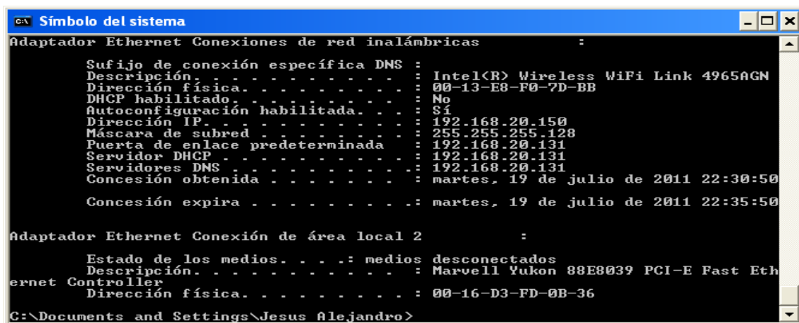
Figura 4.26 Dirección IP del usuario móvil que obtuvo mediante DHCP al conectarse con el primer AP.
