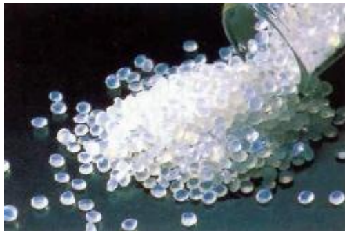
Figura 2.2 Presentación del material a extrudir en forma de pellets
