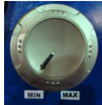
Fig. 5.5. Perilla principal del variador de frecuencia
