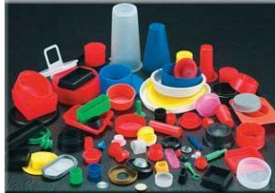
Figura 1.8 Aplicaciones del proceso de inyección
