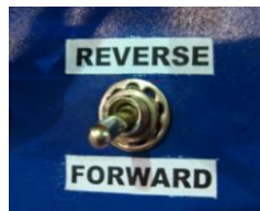
Fig. 5.4. Interruptor (reverse - forward) del variador de frecuencia
