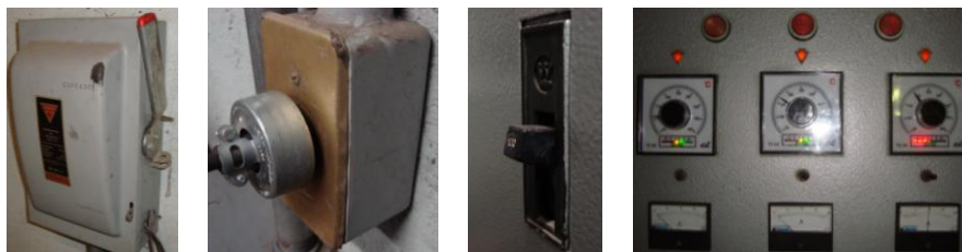
Figura 5.6. Pasos a seguir para encender la extrusora y activar el perfil de temperaturas
