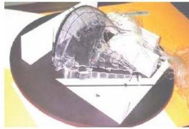
(a) Modelo rígido de una cubierta deformable (Puerto, 2008).
