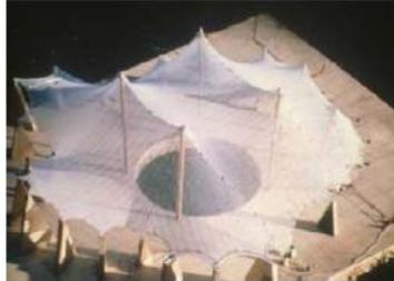
(c) Modelo flexible de una cubierta para determinación de coeficientes (Barnes M.).
