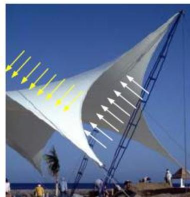
Figura 3.2. Modelo de la cubierta para determinar la distribución de presiones debidas al viento, techo con fronteras rectas
