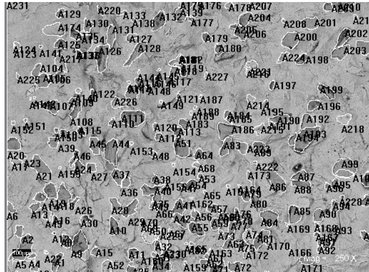
Figura 5.23: Cinta composite con un porcentaje de 21 % (área) de partículas incorporadas mediante el proceso doble rodillo.
