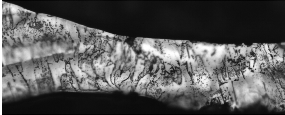
Figura 5.28: Granos columnares para muestra Al-3 % en peso Li solidificada a 2100 m/s
