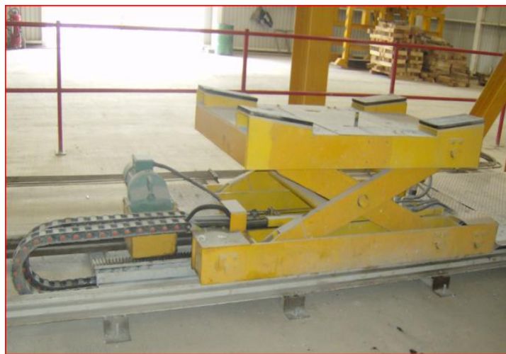
Carro de desalojo con capacidad para una dovela, ubicada en línea de salida de la planta tipo carrusel
