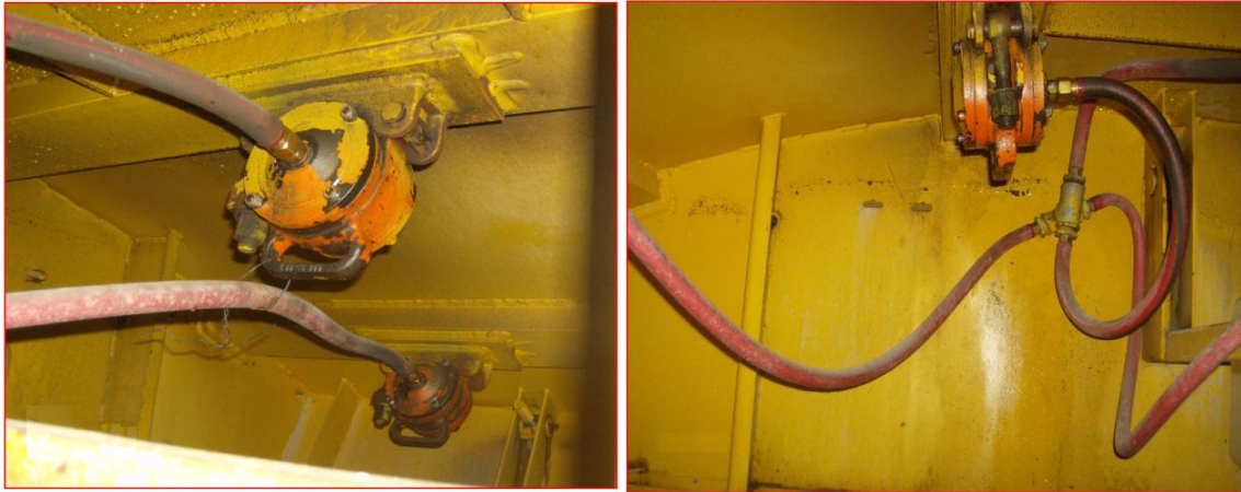
Vibradores neumáticos fijos en el molde
