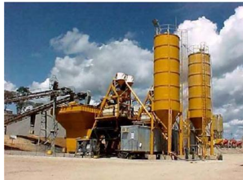
FIG.4.19 EJEMPLO DE CENTRAL GRAVIMETRICA DE CCR. UTILIZADA EN CAÑA BRAVA, BRASIL
