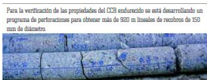
FIG. 2.98 RECOBROS PARA VERIFICAR PROPIEDADES DE CCR
