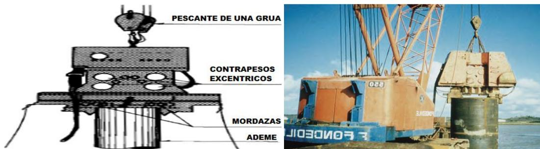
Figura 4.55 Vibrohincador (Manual de Diseño y Construcción de Pilas y Pilotes. México, 1984).
