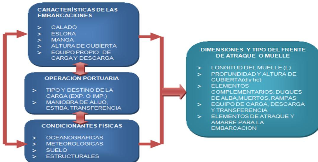
**Figura 1.8. Factores que rigen el dimensionamiento del frente de atraque (Fuente: Manual de Dimensionamiento Portuario S.C.T. México 2011).**
