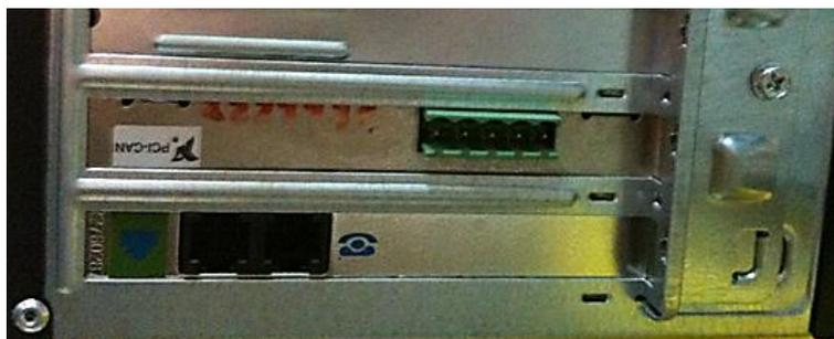
**Figura 2.17. Tarjeta NI PCI-DNET instalada en una computadora.**
