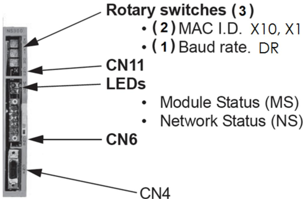
**Figura 2.14. Módulo de servomotores NS300.**
