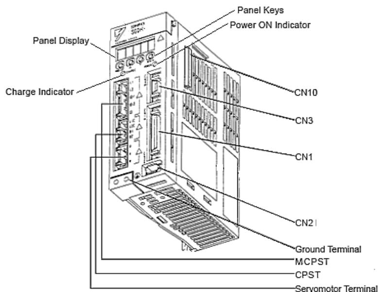
**Figura 2.13. Módulo de potencia SGDH 01AE.**
