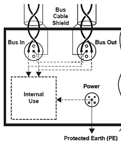
Figura 2.10. Disposición de las conexiones del módulo.
