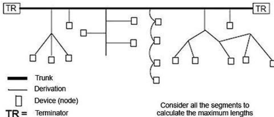
**Figura 1.6 Topología con trunkline y dropline.**
