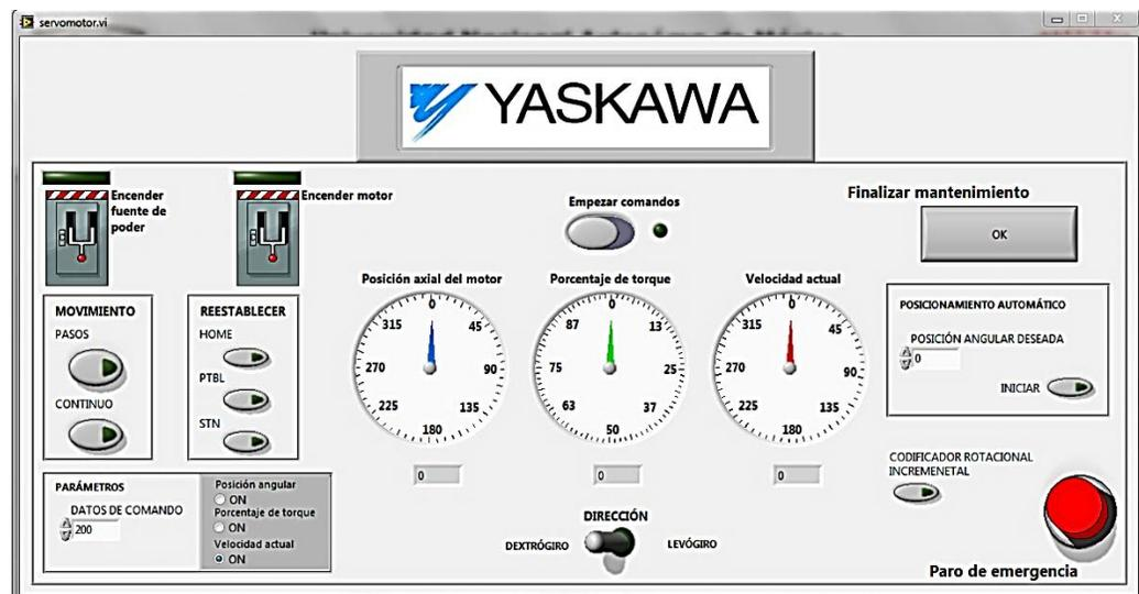
**Figura 4.6. Ventana de mantenimiento especializado al servomotor.**
