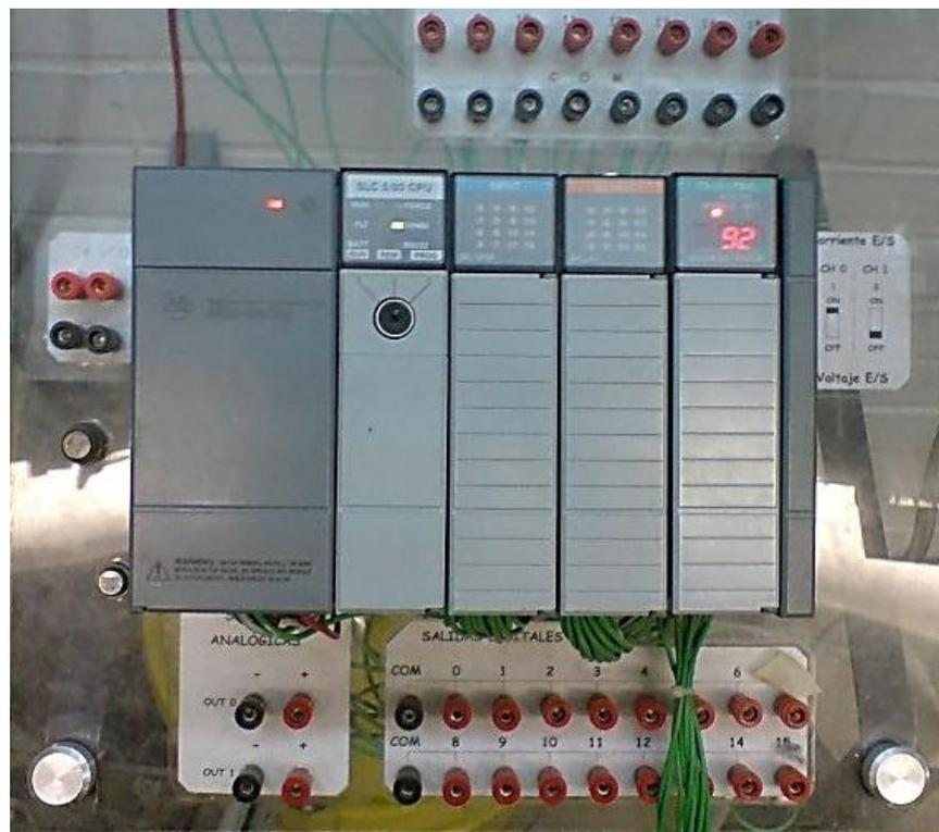
**Figura 2.7. PLC SLC 500 montado en su estación de trabajo con todos los módulos conectados.**
