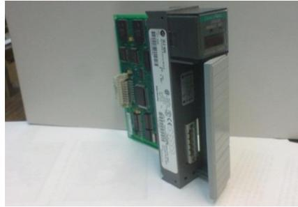
**Figura 2.8. 1747-SDN Scanner DeviceNet®.**
