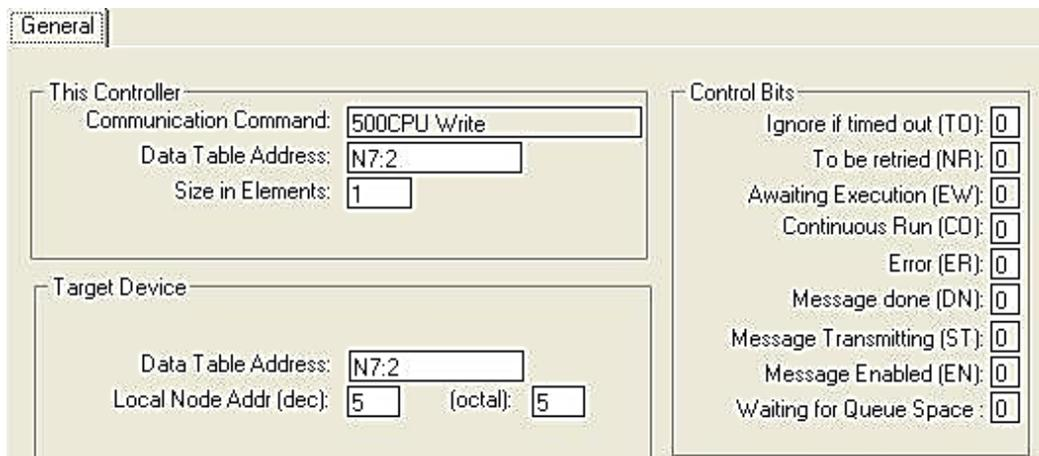
**Figura. 3.15. Bloque de control para el envío del mensaje al SLC500.**
