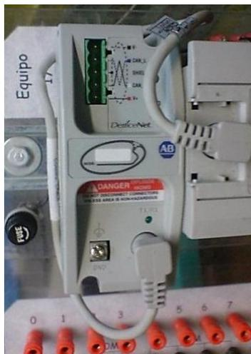
**Figura 2.6 Módulo de interfaz 1761 NET DNI empotrado en la estación de trabajo del PLC al que interpretará.**
