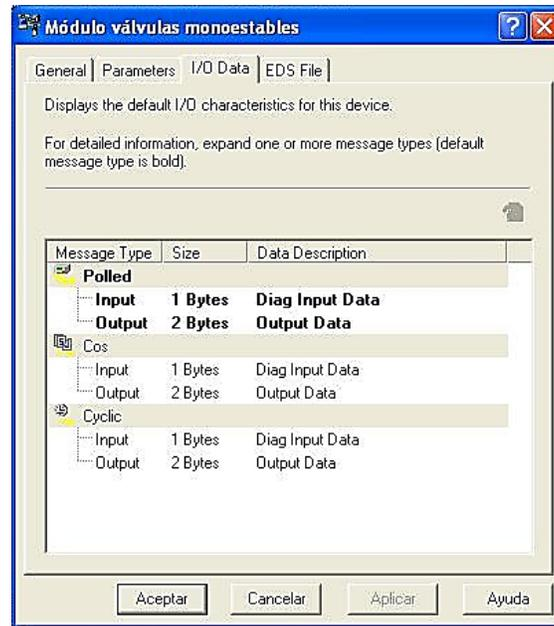
**Figura 3.10. Información de la pestaña "I/O Data" en el módulo de válvulas monoestables.**
