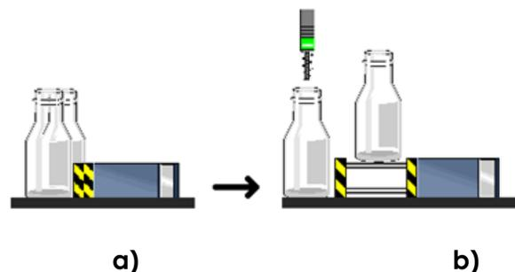
**Figura 2.18. Pistón de dosificado. a) retraído, b) extendido.**
