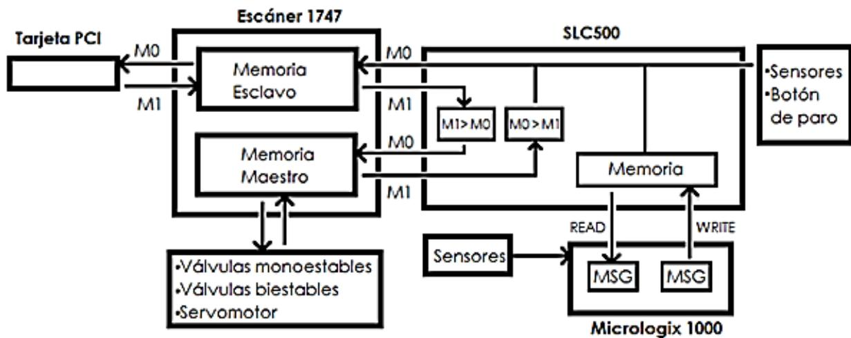
Figura 3.24. Flujo de información para el sistema SCADA.
