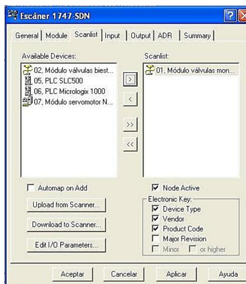
**Figura 3.11. Pestaña "Scanlist" para agregar dispositivos esclavos.**
