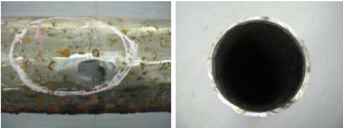
Ilustración 52: Incrustaciones y fractura en tubos de hornos a fuego directo.
