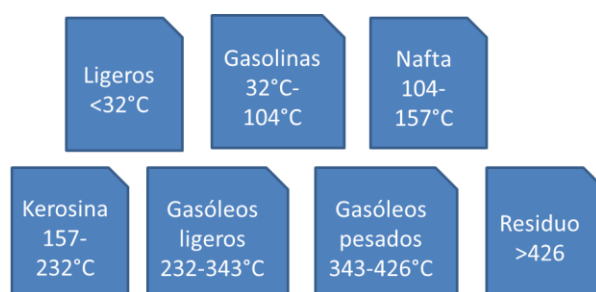
Ilustración 1: Cortes de crudo en función de su temperatura.
