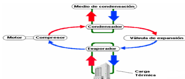
Figura 10: Enfriadora de agua (Chiller)
