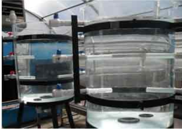
Figura 20. Pruebas de sellado de los SEHA.
