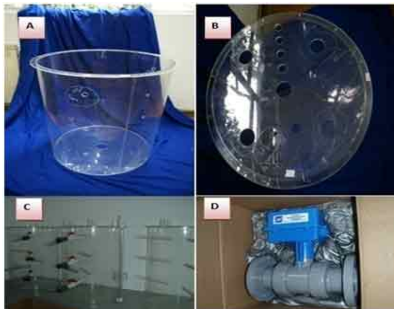
Figura 19. Componentes de los sistemas experimentales que simulan humedales Artificiales: A) Cuerpo de SEHA, B) Tapa superior del SEHA, C) SEHA antes del montaje, D) Electroválvula.
