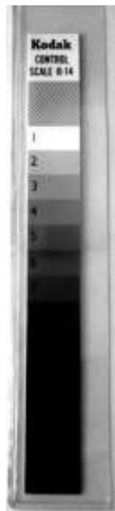
FIGURA 17. Escala de colores para calibración de la cámara
