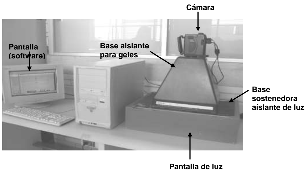
FIGURA 16. Montaje del sistema para la lectura de los geles con el software comercial (Kodak Edas 120)
