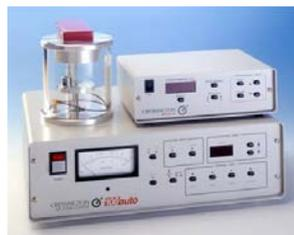
**Figura 34.** Imagen del equipo de sputtering usado para depositar una película metálica en las obleas de  $c$ -Si.
