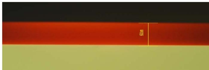
**Figura 11.** Sección transversal de una película de silicio poroso, observada a través de un microscopio óptico. La película porosa se ve roja debido a que está iluminada con luz UV y es fotoluminiscente.
