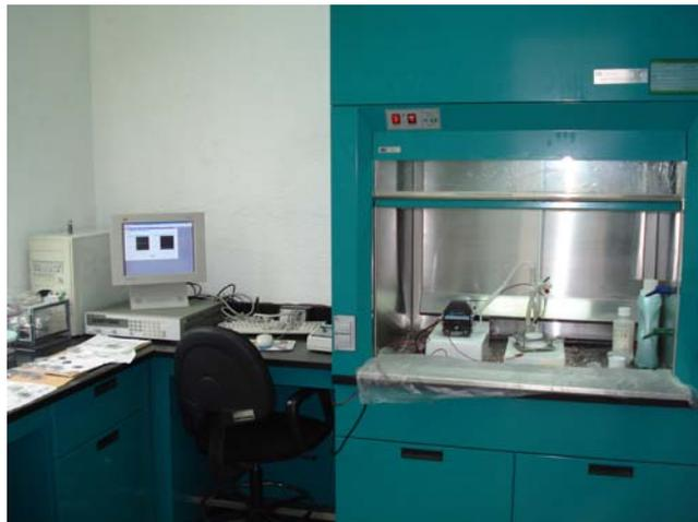
**Figura 19.** Lugar donde se realiza la anodización electroquímica. Se observa la computadora con la que se programa la fuente de corriente, localizada debajo del monitor y la campana de extracción que se utiliza para evitar la acumulación de vapor de HF, dentro de la cual se encuentra la celda electroquímica.
