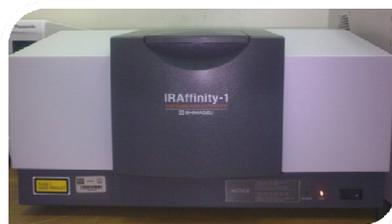
**Figura 38.** Aparato de espectroscopia infrarroja con transformada de Fourier (FTIR) del cual se obtienen espectros de transmitancia.
