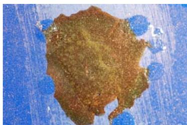
**Figura 37.** Imagen de una multicapa de *p*-Si sin sustrato. La película se coloca sobre el soporte de plástico azul, el cual tiene un orificio debajo del lugar donde se encuentra la película.
