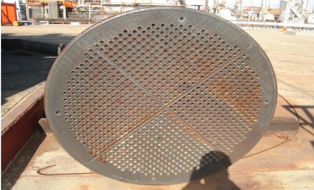
Figura 20. Espejo de un cambiador de calor.
