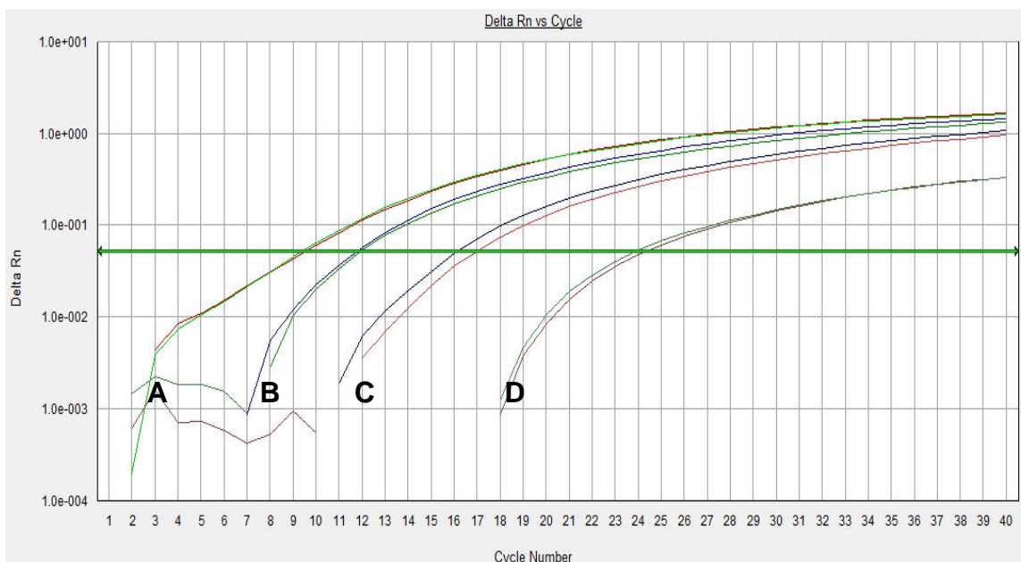
Figura 5.11. Curvas de amplificación de la curva patrón PCR tiempo real de L. casei (Duplicados de extracción de ADN). Concentraciones (A) 10 9 UFC/mL, (B) 10 8 UFC/mL, (C) 10 7 UFC/mL, (D) 10 6 UFC/mL.
